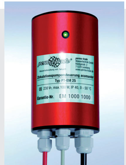
Die bedarfsgerechte Zirkulationspumpensteuerung ecomaster ist prozessor-gesteuert und befördert Warmwasser nur dann, wenn es tatsächlich gebraucht wird. Damit bleibt der Komfort erhalten und trotzdem werden vor allem bei schlecht gedämmten Zirkulationsleitungen große Mengen an Energie eingespart.
