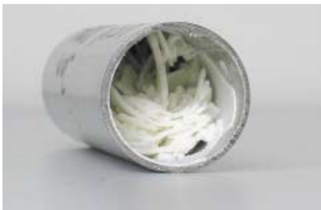
Auch Edelstahl-Rohre sind anfällig für die Verstopfung durch abgeplatzte Kalkbeläge.
