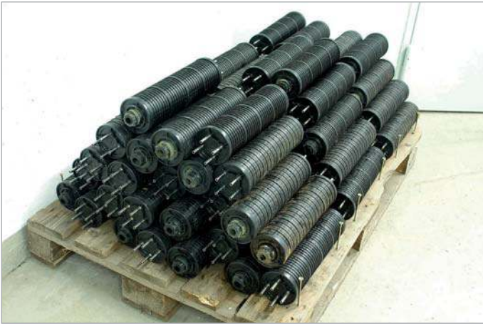
60 Wirkeinheiten können insgesamt 36.000 m 3 Trinkwasser behandeln. Das reicht im Collini-Center für 15 Monate und entspricht 19 t Regeneriersalz, 680 m 3 Trinkwasser und 4.350 l Dosierchemikalien.
